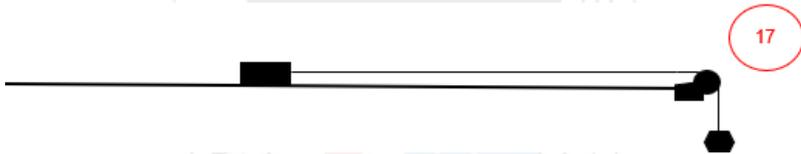
Puede hacer una medición de velocidad, calculando distancia y tiempo. En concreto está midiendo la **variación de velocidad**, ya que el bloque parte del reposo.
